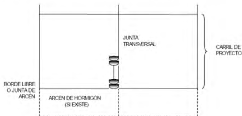
Figura A10.2 Posición crítica del eje tándem de carga para el análisis de erosión
