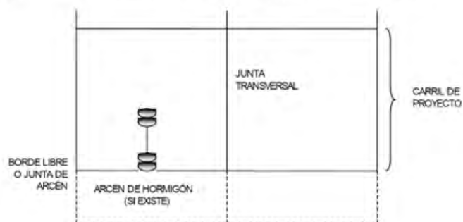
Figura A10.1. Posición crítica del eje tándem de carga para el análisis de fatiga
