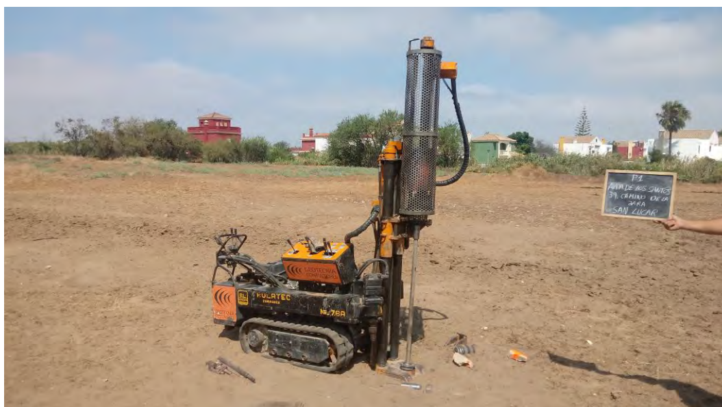
ENSAYO DE PENETRACIÓN DINÁMICA CONTINUA Nº 1
