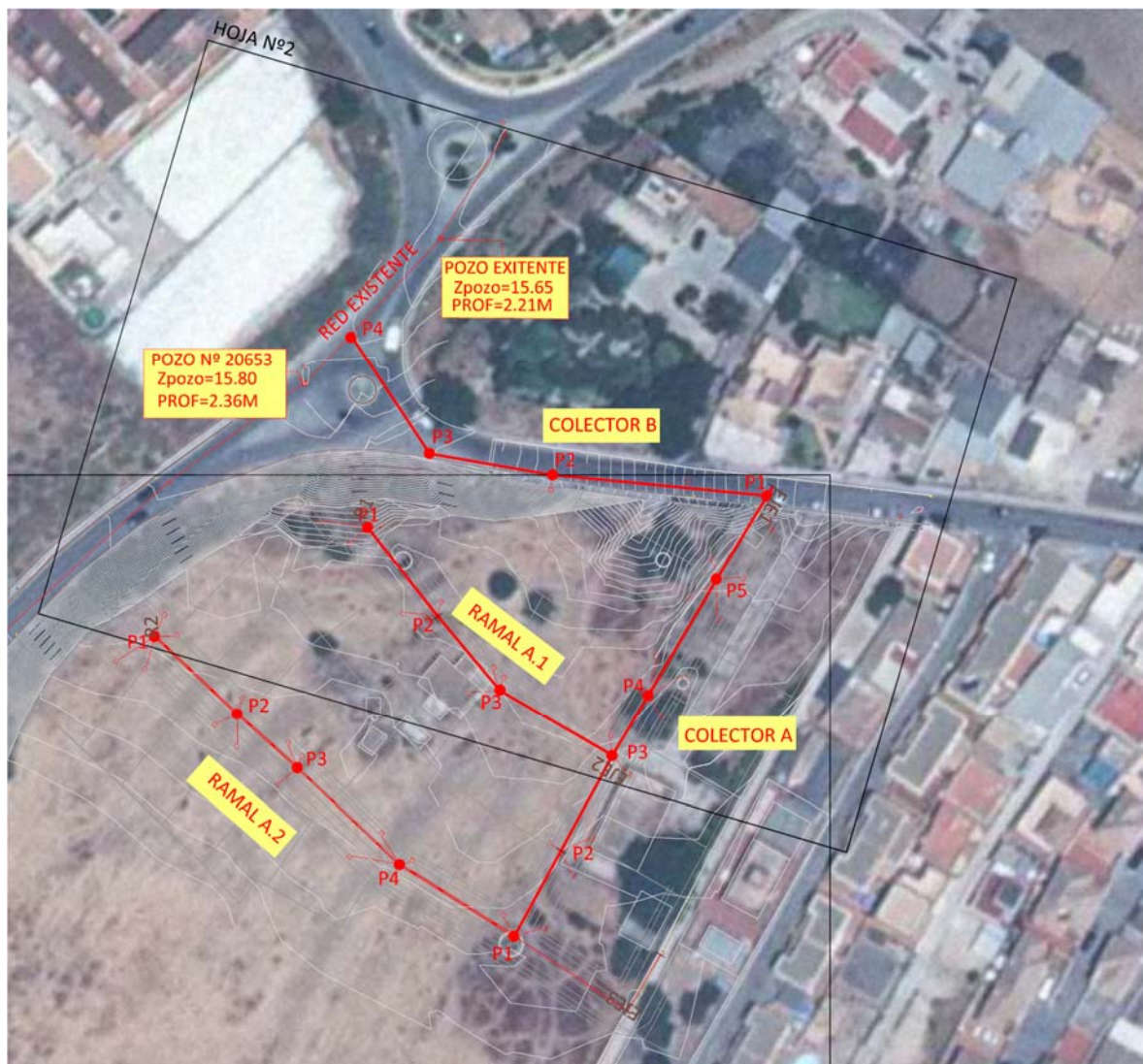
Ilustración 1. Conexión Fecales con registro existente
