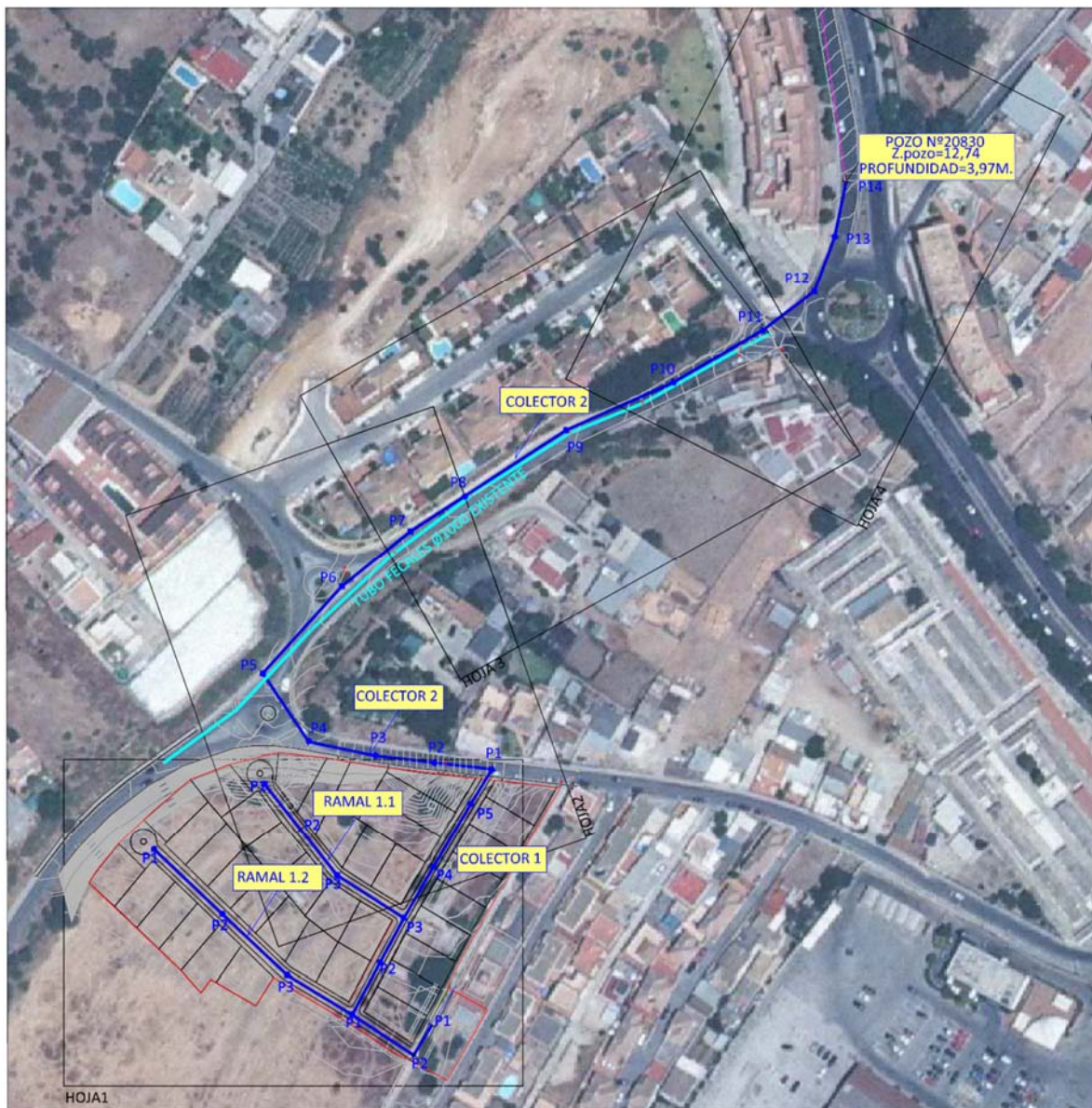
Ilustración 2. Servicios existentes en la traza del colector de pluviales hasta punto de conexión
